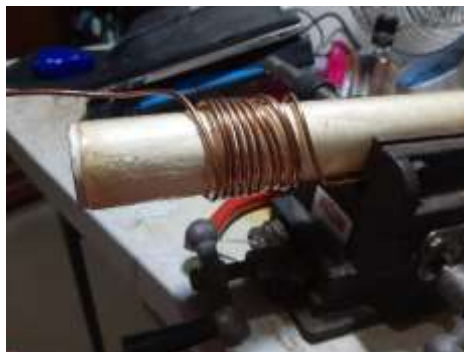
Gambar 3 Pembuatan kumparan tembaga
